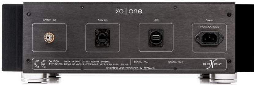
Einen D/A-Wandler hat der xo one nicht an Bord, er überträgt seinen Datenstrom via S/PDIF-Ausgang (l.). WBT, Neutrik und Furutech liefern die Buchsen.
